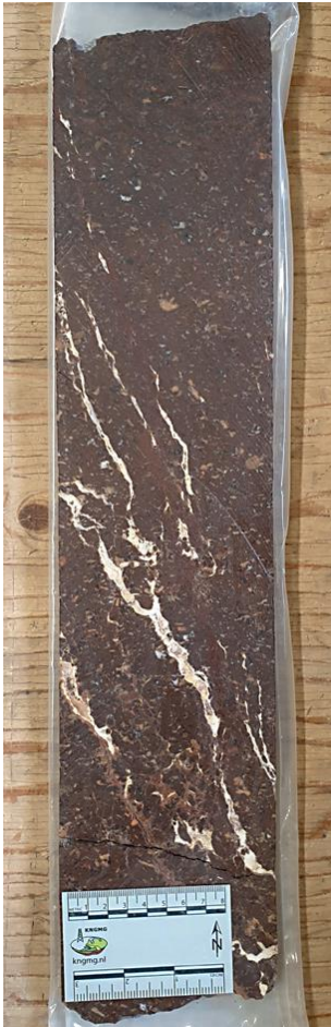
Figuur 3. Boorkern met stollingsgesteente van boring F04-02-A op 4650m diepte langs het boorgat. Bron: Uit het kernhuis via Geert-Jan Visser.
